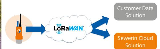
**Engagierter Einsatz:** Laurent Soubrouillard und Amelie Collignon überwachen kommunale Trinkwassernetze mithilfe von LoRaWAN®. Der Kunde entscheidet, ob die Loggerdaten in das bestehende Netzinformationssystem übertragen werden oder ob die Sewerin-Cloud-Lösung genutzt wird.
