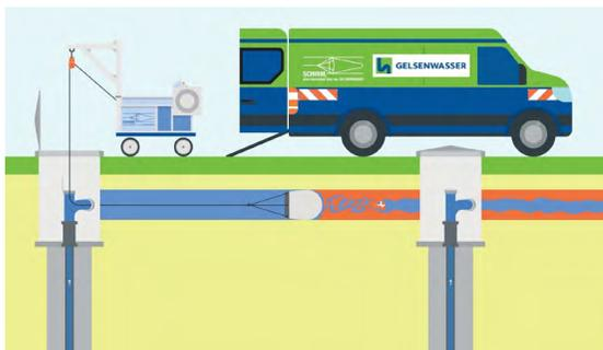
**Ausgereiftes Verfahren:** Mit der Schirmspülung werden Ablagerungen in Rohrleitungen effektiv ausgespült.
